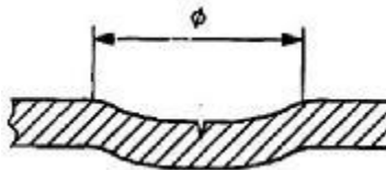
Hình A.2 – Vết lõm có chứa vết rách hoặc đục
